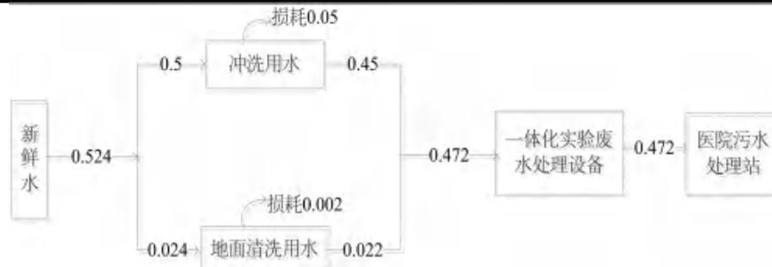
图 2-1 项目水平衡图单位： $\text{m}^3/\text{d}$
