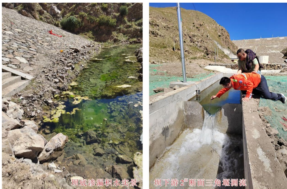
图4.1-3 恰让水库坝底渗漏成河与监测断面测流
